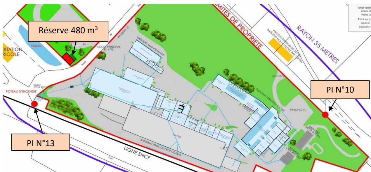
Localisation des ressources existantes en eau d'extinction
